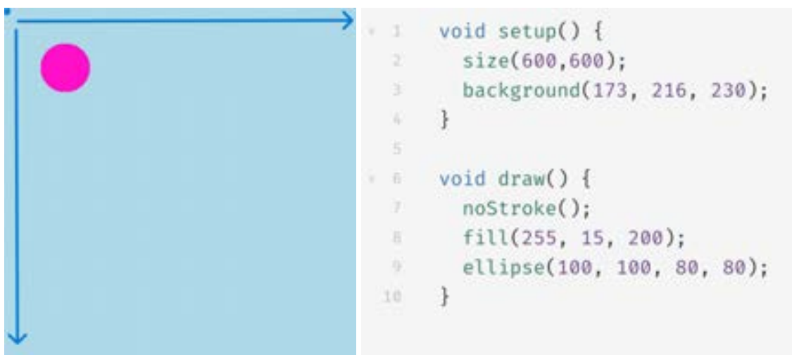
Figura 6: Exemplo de código em Processing que cria uma elipse com largura e altura de 100 pixels, posicionada a 80 pixels da esquerda da tela, e a 80 pixels do topo da tela - função ellipse , na penúltima linha do código.
