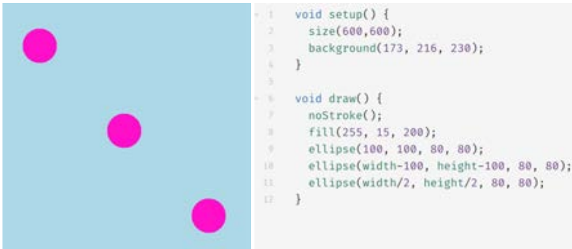
Figura 7: O código para o posicionamento diagonal de três elipses.
