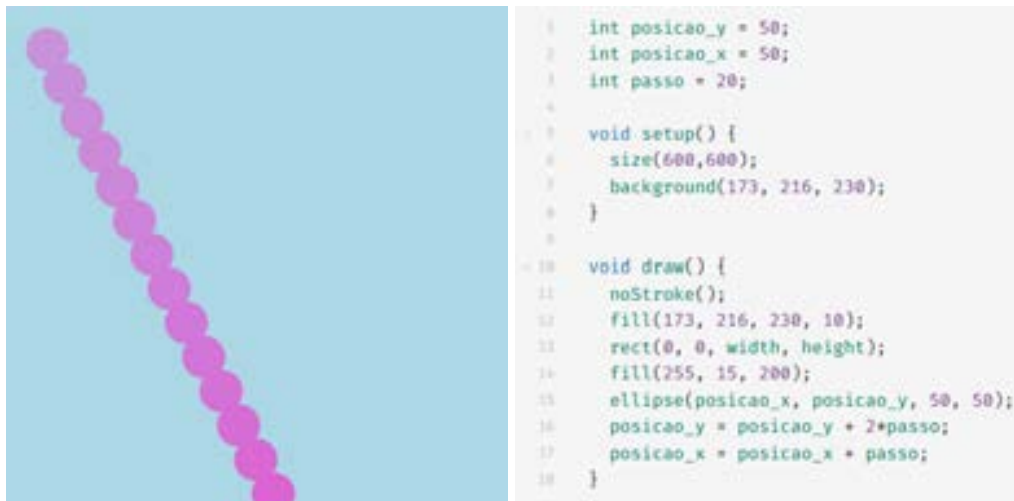
Figura 13: Uma variação do código da figura anterior, mostrando a bolinha com o dobro da velocidade vertical.
